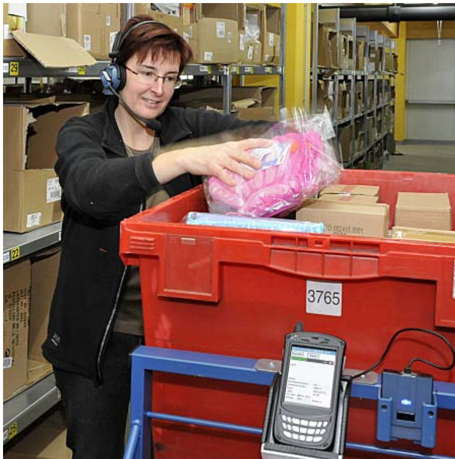
Bild 2: Kabellos sprachgeführt kommissionieren mit GODBM.voice
