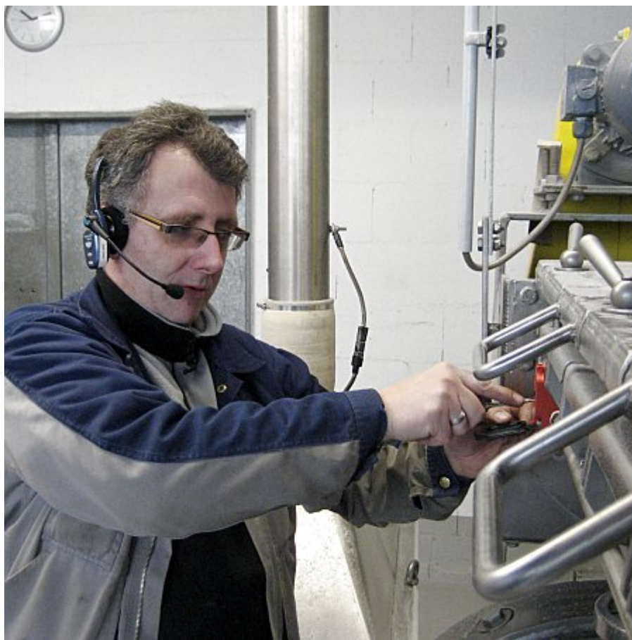
Bild 2: GODBM.checkmaster: Sprachgesteuerte Wartungs- und Prüfabläufe
